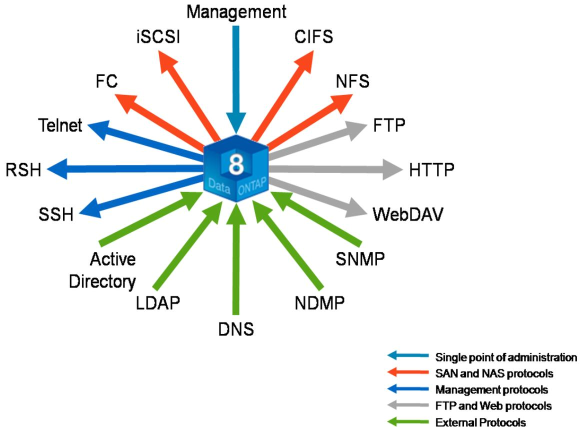
**FIGURE 3 - PROTOCOLS SUPPORTED BY THE NETAPP FAS CONTROLLERS**
